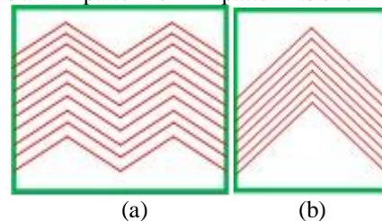
Fig. 5 a) High Theta Plate b) Low Theta Plate
