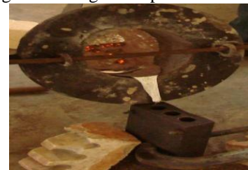
Fig. Pouring the molten
